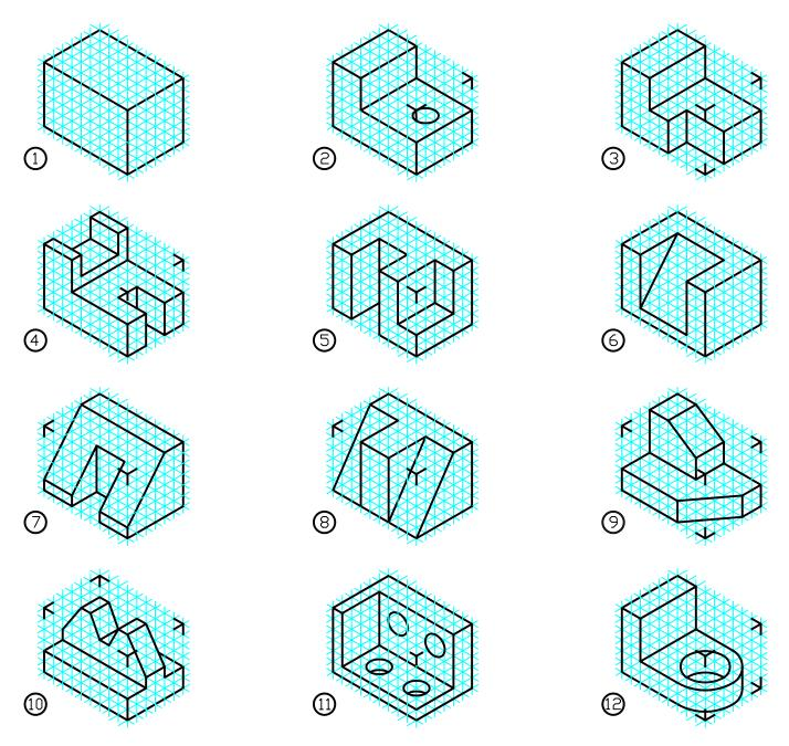
DRTHDGRAPHIC WORK SHEET REDRAW THE ABOVE SHAPES ON ORTHOGRAPHIC GRID PAPER SHOWING THE TOP, FRONT AND RIGHT SIDE VIEWS
